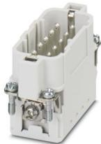
Kontakteinsatz, Polzahl: 10+PE, Baugröße: D15, Anzahl der Anschlüsse je Pol: 1, Stift, Push-in-Anschluss, 250 V, 16 A, 0,14 mm<sup>2</sup> ... 2,5 mm<sup>2</sup>
