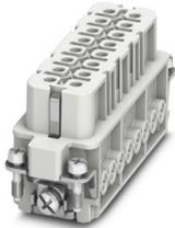
Kontakteinsatz, Polzahl: 16+PE, Baugröße: D25, Buchse, Schraubanschluss, 250 V, 16 A, 0,5 mm<sup>2</sup> ... 2,5 mm<sup>2</sup>
