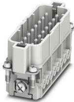
Kontakteinsatz, Polzahl: 16+PE, Baugröße: D25, Stift, Schraubanschluss, 250 V, 16 A, 0,5 mm<sup>2</sup> ... 2,5 mm<sup>2</sup>
