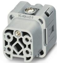
Kontakteinsatz, Polzahl: 4+PE, Baugröße: D7, Anzahl der Anschlüsse je Pol: 1, Buchse, Schraubanschluss, 230 V/400 V, 10 A, 0,5 mm<sup>2</sup> ... 2,5 mm<sup>2</sup>
