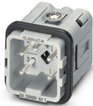
Kontakteinsatz, Polzahl: 4+PE, Baugröße: D7, Anzahl der Anschlüsse je Pol: 1, Stift, Schraubanschluss, 230 V/400 V, 10 A, 0,5 mm<sup>2</sup> ... 2,5 mm<sup>2</sup>
