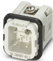
Kontakteinsatz, Polzahl: 3+PE, Baugröße: D7, Anzahl der Anschlüsse je Pol: 1, Stift, Schraubanschluss, 230 V/400 V, 10 A, 0,5 mm<sup>2</sup> ... 2,5 mm<sup>2</sup>
