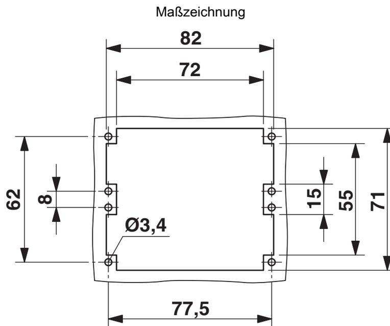
Montageausschnitt bei Verwendung ohne Gehäuse
