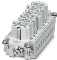
Kontakteinsatz, Polzahl: 16+PE, Baugröße: B16, Buchse, Schraubanschluss, 500 V, 16 A, 0,5 mm<sup>2</sup> ... 2,5 mm<sup>2</sup>
