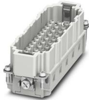
Kontakteinsatz, Polzahl: 46+PE, Baugröße: B24, Anzahl der Anschlüsse je Pol: 1, Stift, Crimpanschluss, 500 V, 16 A, 0,5 mm<sup>2</sup> ... 4 mm<sup>2</sup>
