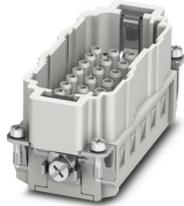
Kontakteinsatz, Polzahl: 32+PE, Baugröße: B16, Anzahl der Anschlüsse je Pol: 1, Stift, Crimpanschluss, 500 V, 16 A, 0,5 mm<sup>2</sup> ... 4 mm<sup>2</sup>
