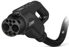
CHARX connect standard, GB/T, DC-Ladeleitung, 250 A dauerhaft, 1000 V DC, mit Fahrzeug-Ladestecker und offenem Leitungsende, Kabel: 5 m, gerade, mit Schutzkappe, mit analoger Temperatursensorik, PHOENIX CONTACT-Logo, GB/T 20234.1-2015, GB/T 20234.3-2015, zum Laden mit Gleichstrom (DC) von Elektrofahrzeugen (EV)
