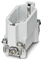
Kontakteinsatz, Polzahl: 15+PE, Baugröße: D15, Anzahl der Anschlüsse je Pol: 1, Stift, Crimpanschluss, 250 V, 10 A, 0,14 mm<sup>2</sup> ... 2,5 mm<sup>2</sup>
