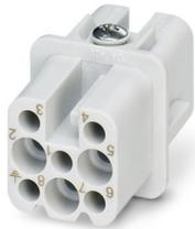
Kontakteinsatz, Polzahl: 8, Baugröße: D7, Anzahl der Anschlüsse je Pol: 1, Buchse, Crimpanschluss, 42 V, 10 A, 0,14 mm<sup>2</sup> ... 2,5 mm<sup>2</sup>
