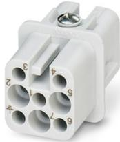
Kontakteinsatz, Polzahl: 7+PE, Baugröße: D7, Anzahl der Anschlüsse je Pol: 1, Buchse, Crimpanschluss, 250 V, 10 A, 0,14 mm<sup>2</sup> ... 2,5 mm<sup>2</sup>, nur für Kunststoffgehäuse geeignet
