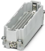
Kontakteinsatz, Polzahl: 108+PE, Baugröße: B24, Stift, Crimpanschluss, 250 V, 10 A, 0,14 mm<sup>2</sup> ... 2,5 mm<sup>2</sup>, Anwendung: Signal
