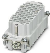
Kontakteinsatz, Polzahl: 72+PE, Baugröße: B16, Buchse, Crimpanschluss, 250 V, 10 A, 0,14 mm<sup>2</sup> ... 2,5 mm<sup>2</sup>, Anwendung: Signal
