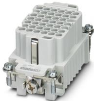
Kontakteinsatz, Polzahl: 42+PE, Baugröße: B10, Anzahl der Anschlüsse je Pol: 1, Buchse, Crimpanschluss, 250 V, 10 A, 0,14 mm<sup>2</sup> ... 2,5 mm<sup>2</sup>, Anwendung: Signal
