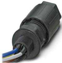
Wanddurchführung, Anschlussart: Einzeladern (angeschweißt), Polzahl: 4+PE, M25, Stift, 1 mm<sup>2</sup> ... 2,5 mm<sup>2</sup>, 690 V, 20 A, PA, schwarz, mit QUICKON-Mutter, Kodierung: kodiert, Leitungsaußendurchmesser: 6 mm ... 11 mm, 2,5 mm<sup>2</sup>, Adern glatt abgeschnitten, Leitungslänge: 0,5 m
