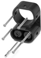
CHARX connect standard, CCS Typ 2, Reparatur-Kit, Zubehör, Gehäuse: schwarz, mit austauschbarem Steckgesichtrahmen, mit 5 Stück M4X10-Flachkopfschrauben mit Torx-Sicherheitsantrieb (IPR TORX PLUS®), mit speziellem Bit (867/4 IPR TORX PLUS® Bit, 20 IPR x 89 mm) für Sicherheitserschraubendreher, mit integriertem vorderen Teil der DC-Kontakte, für Austausch des Steckgesichtrahmens von Fahrzeug-Ladesteckern, IEC 62196-3
