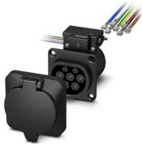
CHARX connect modular, Typ 2, Infrastruktur-Ladedose, 32 A , 480 V AC, Basic, Set, Einzeladern, Verriegelungsaktuator: 12 V, 4-polig, eckig, Rückwandmontage, M5-Gewinde, Gehäuse: schwarz, mit eckigem Schutzdeckel, zum Laden mit Wechselstrom (AC) von Elektrofahrzeugen (EV), Ohne Logo, IEC 62196-2
