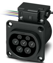
CHARX connect modular, Typ 2, Infrastruktur-Ladedose, 32 A , 480 V AC, Basic, ohne Einzeladern, Verriegelungsaktuator: 12 V, 4-polig, eckig, Rückwandmontage, M5-Gewinde, Gehäuse: schwarz, zum Laden mit Wechselstrom (AC) von Elektrofahrzeugen (EV), PHOENIX CONTACT-Logo, IEC 62196-2
