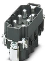
Kontakteinsatz, Polzahl: 6+PE, Baugröße: B16, Leistungskontakte: 6, Steuerkontakte: 0, Stift, Schraubanschluss, 1000 V, 80 A, 6 mm<sup>2</sup> ... 16 mm<sup>2</sup>, Anwendung: Leistung
