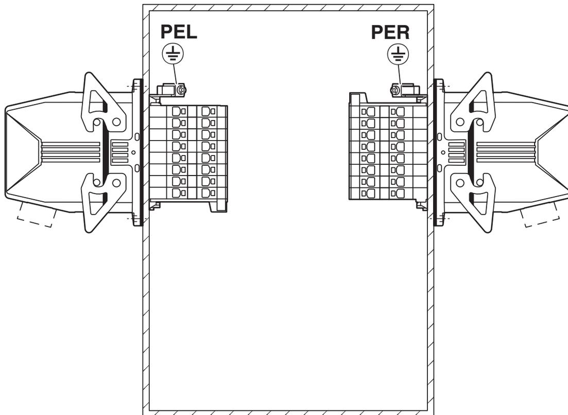
Einbaulage PE-Anschluss links / rechts (PEL / PER)
