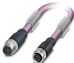
Bussystem-Kabel, PROFIBUS, 2-polig, PUR halogenfrei, violett RAL 4001, geschirmt, Stecker gerade M12, Kodierung: B, auf Buchse gerade M12, Kodierung: B, Kabellänge: 9 m
