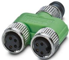
Y-Verteiler, 4-polig, ungeschirmt, Stecker gerade M8, Kodierung: A, auf Buchse gerade M8, Kodierung: A und Buchse gerade M8, Kodierung: A, parallel Verteiler
