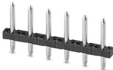
Stiftleiste, Nennquerschnitt: 1,5 mm<sup>2</sup>, Farbe: grau, Nennstrom: 12 A (Abhängig von verwendetem Stecker), Bemessungsspannung (III/2): 320 V, Kontaktoberfläche: Sn, Kontaktart: Stift, Anzahl der Reihen: 1, Polzahl: 5, Artikelfamilie: PST 1,3/..-V, Rastermaß: 5 mm, Montage: THR-Löten / Wellenlöten, Pin-Layout: Lineares Pinning, Pinlänge [P]: 3,5 mm, Stecksystem: COMBICON PST 1,3, Verriegelung: ohne, Befestigungsart: ohne, Verpackungsart: verpackt im Karton
