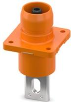
Steckverbinder, Artikelfamilie: BPC 250, Farbe: orange, Polzahl: 1, Bemessungsspannung: 1500 V DC, Bemessungsstrom: 250 A, Anschlussart: Gewindeanschluss
