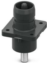
Steckverbinder, Artikelfamilie: BPC 120, Farbe: schwarz, Polzahl: 1, Aderquerschnitt min.: 16 mm<sup>2</sup>, Aderquerschnitt max.: 25 mm<sup>2</sup>, Bemessungsspannung: 1500 V DC, Bemessungsstrom: 120 A, Anschlussart: Gewindeanschluss
