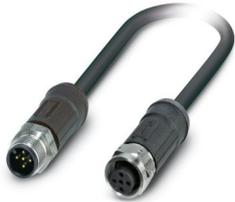
Bussystem-Kabel, CANopen®, DeviceNet™, 5-polig, FRNC halogenfrei, schwarz, geschirmt, Stecker gerade M12, Kodierung: A, auf Buchse gerade M12, Kodierung: A, Kabellänge: 0,64 m, für Außenanwendungen, mit Edelstahlrändel
