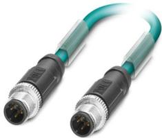
Netzwerkkabel, Ethernet CAT5 (100 MBit/s), 4-polig, PUR halogenfrei, wasserblau RAL 5021, geschirmt (Advanced Shielding Technology), Stecker gerade M12, Kodierung: D / IP67, auf Stecker gerade M12, Kodierung: D / IP67, Kabellänge: 1 m
