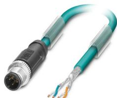
Netzwerkkabel, Ethernet CAT5 (100 MBit/s), 4-polig, PUR halogenfrei, wasserblau RAL 5021, geschirmt (Advanced Shielding Technology), Stecker gerade M12, Kodierung: D / IP67, auf freies Leitungsende, Kabellänge: 10 m
