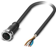
Sensor-/Aktor-Kabel, 4-polig, PUR halogenfrei, schwarzgrau RAL 7021, geschirmt (Advanced Shielding Technology), freies Leitungsende, auf Buchse gerade M12 Push-Pull, Kodierung: A, Kabellänge: 1 m
