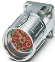
M23, Gerätesteckverbinder Vorderwand mit Rändelmutter, Serie: SH, gerade, geschirmt: ja, SPEEDCON, Polzahl: 6+4+4+PE, 6-poliges Datenelement, Kontaktart: Buchse, Crimpanschluss, O-Ring axial, Flanschmaß: 26 mm x 26 mm
