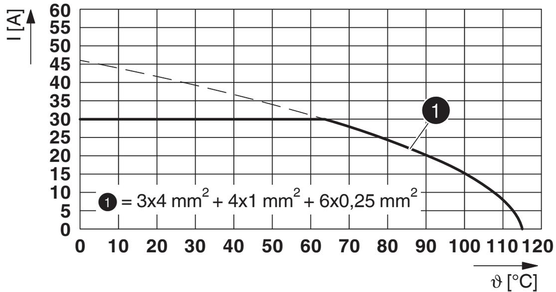
$I$  = Stromstärke,  $\vartheta$  = Umgebungstemperatur, Leistungskontakte A-C: 3 x bis 30 A, Signalkontakte: 4 x 2 A konstant, Datenkontakte: 6 x 1 A konstant
