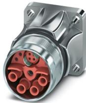
M23, Gerätesteckverbinder Vorderwand, Serie: SH, gerade, geschirmt: ja, für Standard- und SPEEDCON-Verriegelung, Polzahl: 6+4+4+PE, 6-poliges Datenelement, Kontaktart: Buchse, Crimpanschluss, O-Ring axial, Flanschmaß: 26 mm x 26 mm
