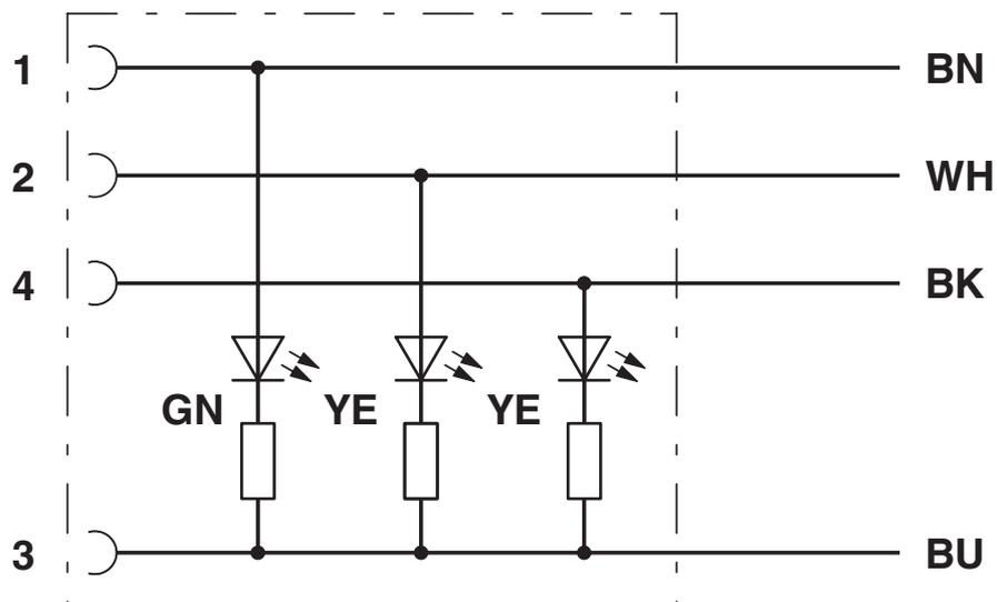
Kontaktbelegung der M12-Buchse mit LED
