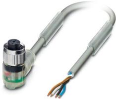
Sensor-/Aktor-Kabel, 4-polig, PUR halogenfrei, schweißfunkenbeständig, hochflexibel, grau RAL 7001, freies Leitungsende, auf Buchse gewinkelt M12, Kodierung: A, mit 3 LEDs, Kabellänge: 5 m, für Roboter und Schleppketten
