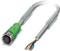
Sensor-/Aktor-Kabel, 4-polig, PUR halogenfrei, schweißfunkenbeständig, hochflexibel, grau RAL 7001, freies Leitungsende, auf Buchse gerade M12, Kodierung: A, Kabellänge: 10 m, für Roboter und Schleppketten
