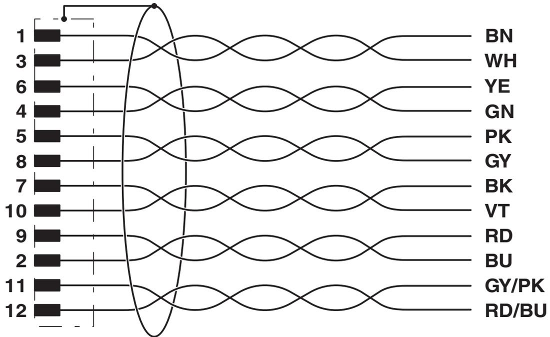
Kontaktbelegung des M12-Steckers
