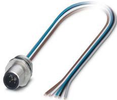
Sensor-/Aktor-Einbaustecker, 5-polig, M12, A-kodiert, Vorderwand-/Schraubmontage mit Pg9-Gewinde, mit 0,115 m TPE-Litze, 5 x 0,34 mm<sup>2</sup>
