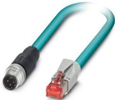
Konfektioniertes Ethernet-Kabel, CAT5e, geschirmt, 2-paarig, AWG 26 flexibel (7-drähtig), RAL 5021 (wasserblau), M12 4-polig D-kodiert auf RJ45-Stecker, Länge: 3 m, Kundenvariante
