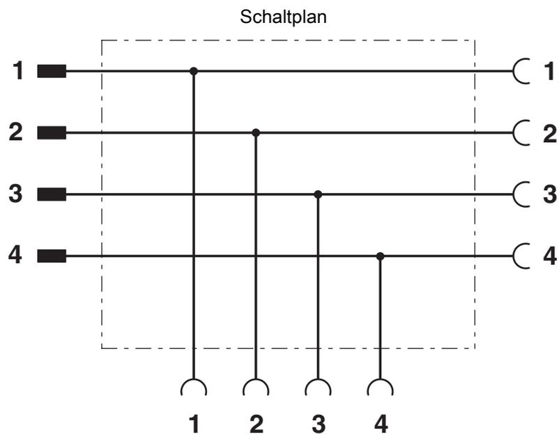
Kontaktbelegung des M12-T-Verteilers
