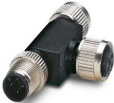
T-Verteiler, CC-Link, 4-polig, ungeschirmt, Stecker gerade M12, Kodierung: A, auf Buchse gerade M12, Kodierung: A und Buchse gerade M12, Kodierung: A, parallel Verteiler
