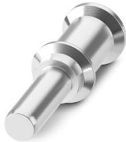
Crimpkontakt, Serie: HC-M-...-25, HC-DCC4-I-CT-HW, Stift, gedreht, Kontaktdurchmesser: 6 mm, Anschlussquerschnitt: 6 mm<sup>2</sup> ... 6 mm<sup>2</sup>, AWG 10...10, Material Kontakt: Cu-Legierung
