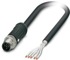
Sensor-/Aktor-Kabel, 5-polig, PE-X halogenfrei, schwarz, Stecker gerade M12 SPEEDCON, Kodierung: A, auf freies Leitungsende, Kabellänge: 0,25 m, für Bahnanwendungen
