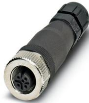
Sensor-/Aktor-Buchse, gerade, 5-polig, M12, A-kodiert, Schraubanschluss, Metallrändel, Kabelverschraubung Pg7 SKINTOP®
