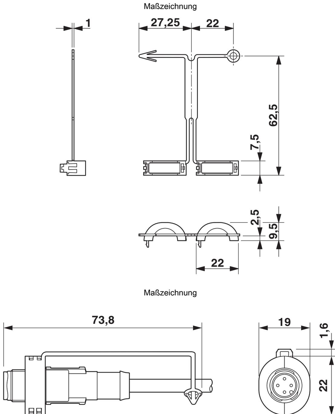
Sicherungsclip montiert auf geradem M12-Steckverbinder (nicht im Lieferumfang enthalten)
