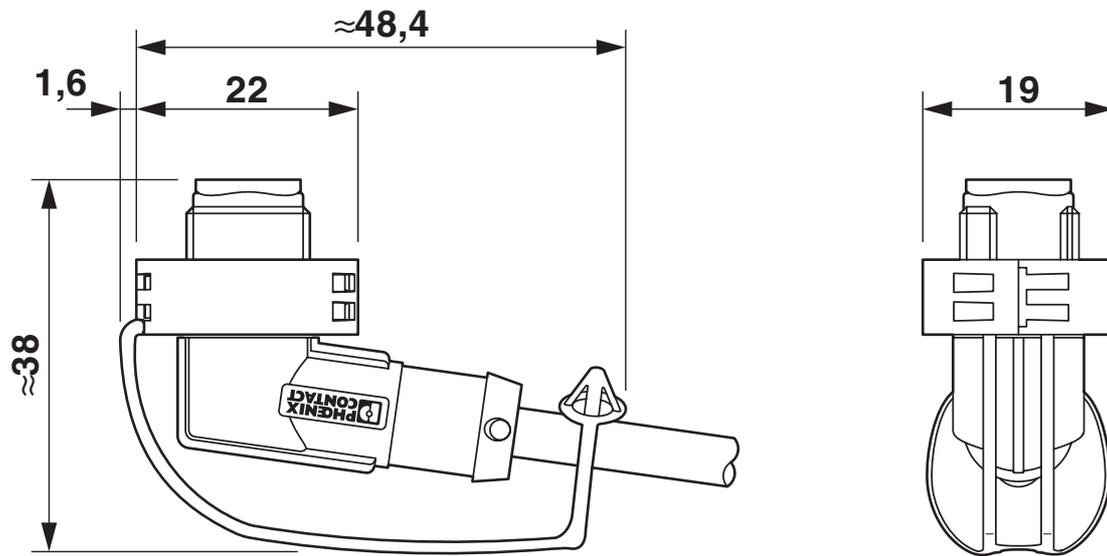
Sicherungsclip montiert auf gewinkeltem M12-Steckverbinder (nicht im Lieferumfang enthalten)
