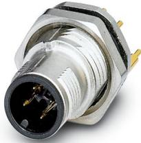
Gerätesteckverbinder Hinterwand, 4-polig, Stift, gerade, M12-SPEEDCON, A-Kodierung, Wellenlöten, dieser Artikel ist voraussichtlich ab 2026-Q2 nach RoHS II ohne Ausnahme 6c (Pb < 0,1 %) bleifrei, auf Anfrage ist eine bleifreie Alternative vorab möglich
