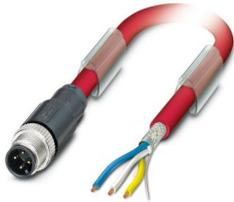
Bussystem-Kabel, CC-Link (10 MBit/s), 4-polig, PVC, rot, geschirmt, Stecker gerade M12, Kodierung: A, auf freies Leitungsende, Kabellänge: 5 m
