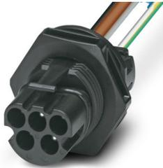
Gerätesteckverbinder Hinterwand, Artikelfamilie: PRC 35, Farbe: schwarz, Polzahl: 5, Aderquerschnitt max.: 6 mm<sup>2</sup>, Bemessungsspannung: 690 V AC, Bemessungsstrom: 35 A, Anschlussart: Crimpanschluss, Dieser Artikel ist auch mit anderen Leitungslängen erhältlich. Für Ihre Bedarfe kontaktieren Sie bitte Ihre lokale Phoenix Contact-Niederlassung.
