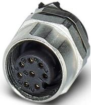
Gerätesteckverbinder Hinterwand, 8-polig, Buchse, gerade, M12-SPEEDCON, Kodierung: A, Hinterwandmontage, M12 x 1, THR-Lötanschluss, dieser Artikel ist voraussichtlich ab 2026-Q2 nach RoHS II ohne Ausnahme 6c (Pb < 0,1 %) bleifrei, auf Anfrage ist eine bleifreie Alternative vorab möglich
