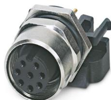
Sensor-/Aktor-Einbaubuchse, 8-polig, M12, A-kodiert, Hinterwand-/Schraubmontage mit M12-Gewinde, verdrehgeschützt, mit geradem Lötanschluss
