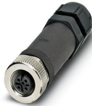
Sensor-/Aktor-Buchse, gerade, 5-polig, M12, A-kodiert, Schraubanschluss, Metallrändel, Kabelverschraubung Pg9 SKINTOP®
