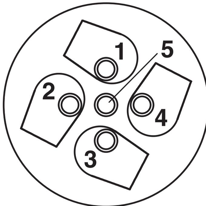
Kabelanschlusseite M12 (Schraubanschluss)
