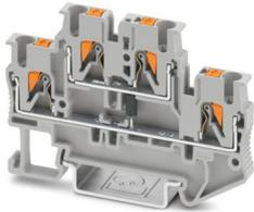
Bauelementreihenklemme, Mit integrierter Diode 1N5408, Nennspannung: 500 V, Nennstrom: 1,5 A, Anzahl der Anschlüsse: 4, Anschlussart: Push-in-Anschluss, Bemessungsquerschnitt: 2,5 mm<sup>2</sup>, Querschnitt: 0,14 mm<sup>2</sup> - 4 mm<sup>2</sup>, Montageart: NS 35/7,5, NS 35/15, Farbe: grau
