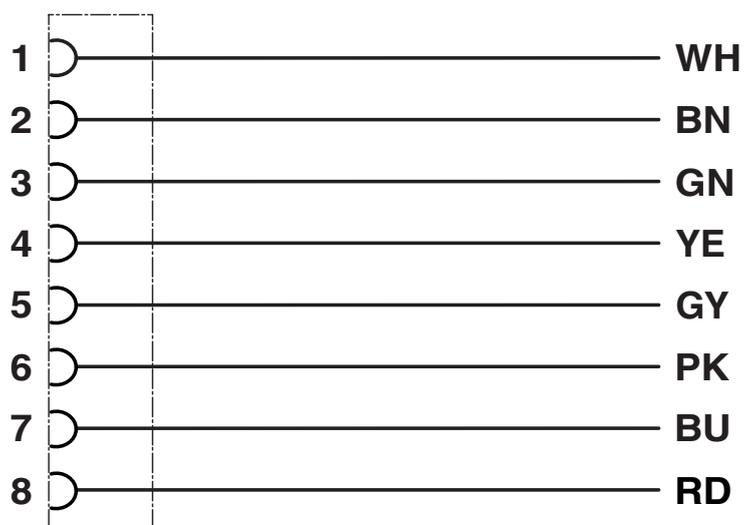
Kontaktbelegung der M12-Buchse
